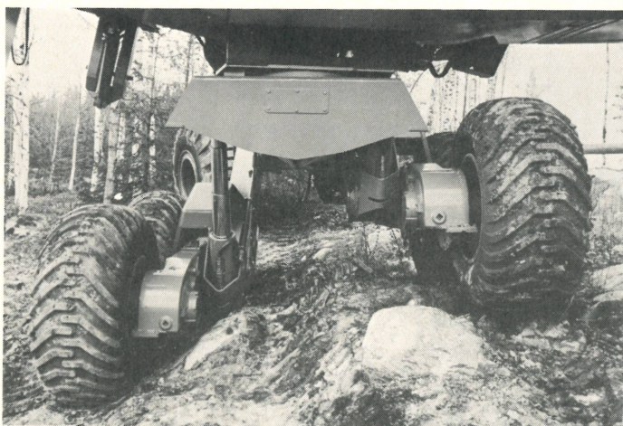
Pendelboggin kan utjämna mycket stora nivåskillnader mellan hjulspåren.
