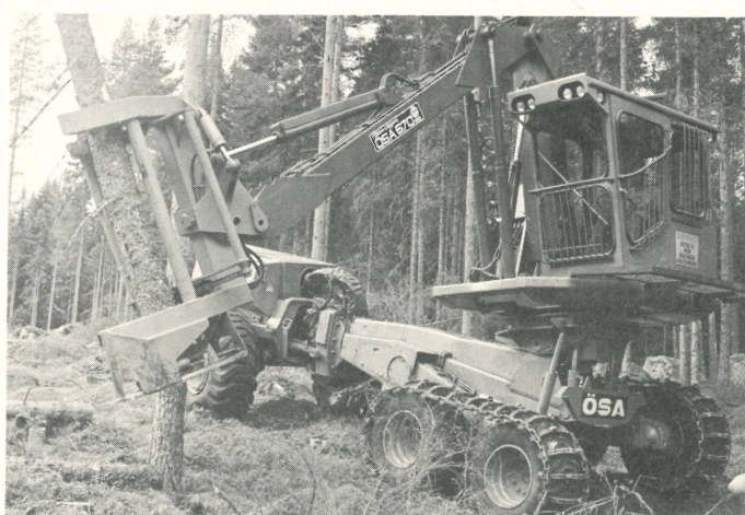
Förarhytten följer kranarmens rörelser och hålls horisontell i lutningar upp till 30 %.
