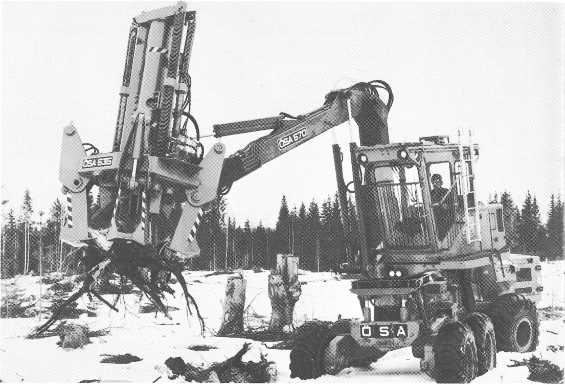
ÖSA stubbupptagare i arbete.
