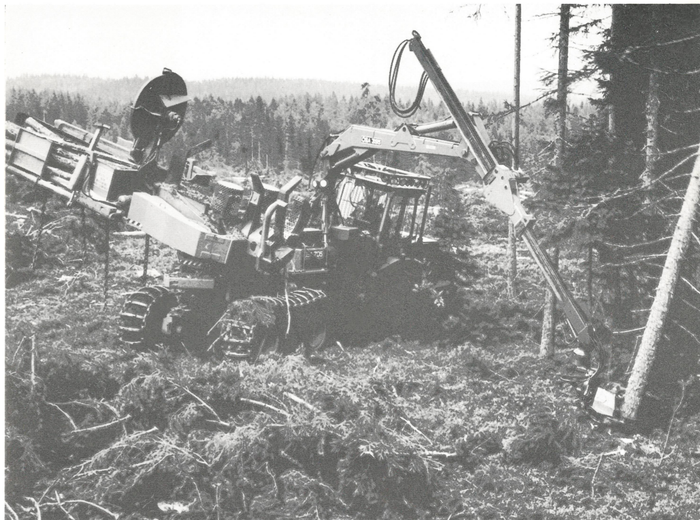
Sedan den vidareutvecklade fällsågen monterats har skördarens utnyttjandegrad på 70 - 80 % vilket måste anses mycket tillfredsställande.
