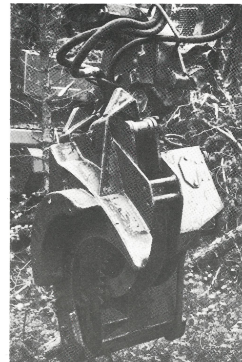
Bland förbättringarna märks en konsol under fällhuvudet som minskar riskerna för stensågning.
