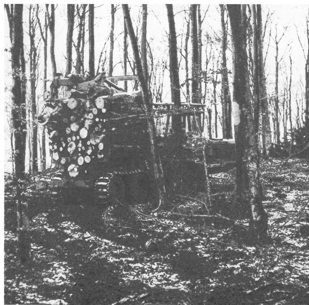
Med ett rejält lass bokvirke kör ÖSA 260 skotaren varsamt genom beståndet. Den långa kranen gör det möjligt att undvika större skador i bokföryngringen.
