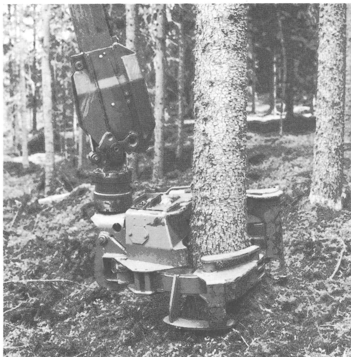
ÖSA 642 fällsåg kommer nu med många förbättringar som ökar dess prestation och driftsäkerhet.
