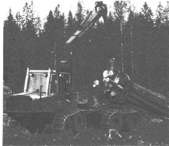
Världens starkaste klämbankslunnare Lokomo 933 har hela 18 tons lastkapacitet och 22 alt. 25 tons dragkraft.
