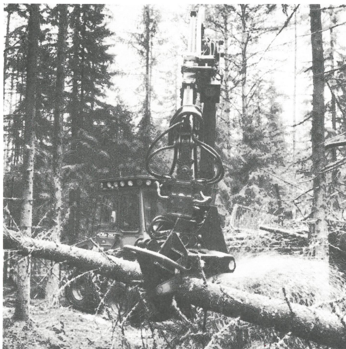
Den nya tånggripsågen i arbete.
