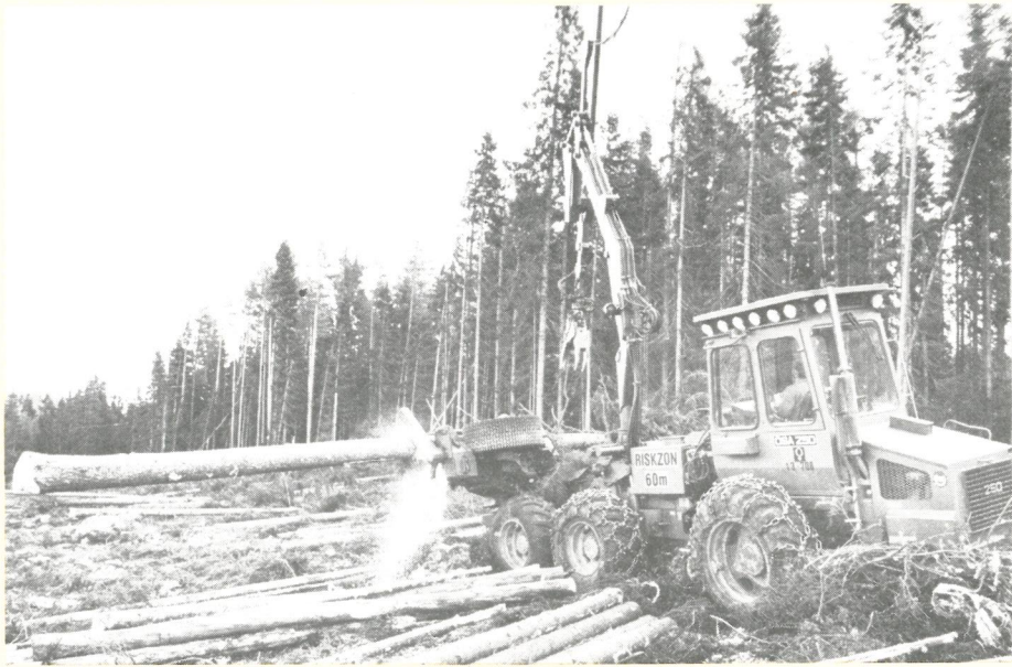
Alla ÖSA 706-skördare och processorer levereras med anordning för sprickfri kapning.
