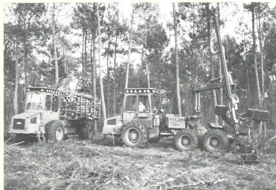
Skördaren ÖSA 706/250 och skotaren ÖSA 250 under provkörning i Les Landes i sydvästra Frankrike.
