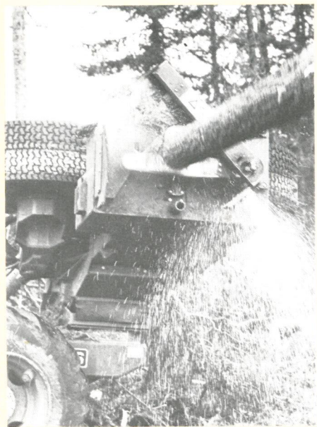
Så här går det till. Tack vare den snabba kedjehastigheten, 47 m/sekund ...
