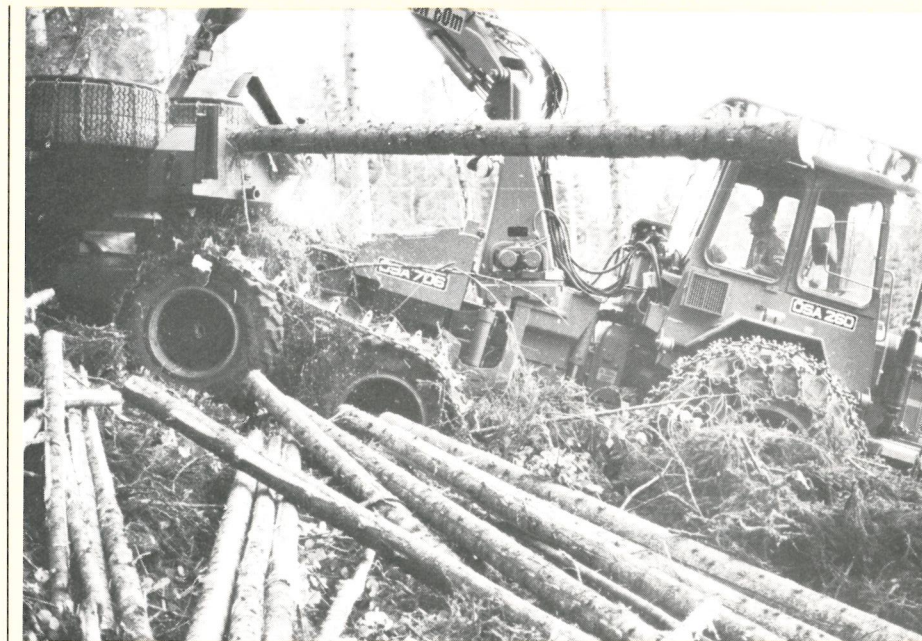
Föraren kan ägna sig åt att fälla nästa träd, under tiden kapas, automatiskt, exakta längder i 706:an.
