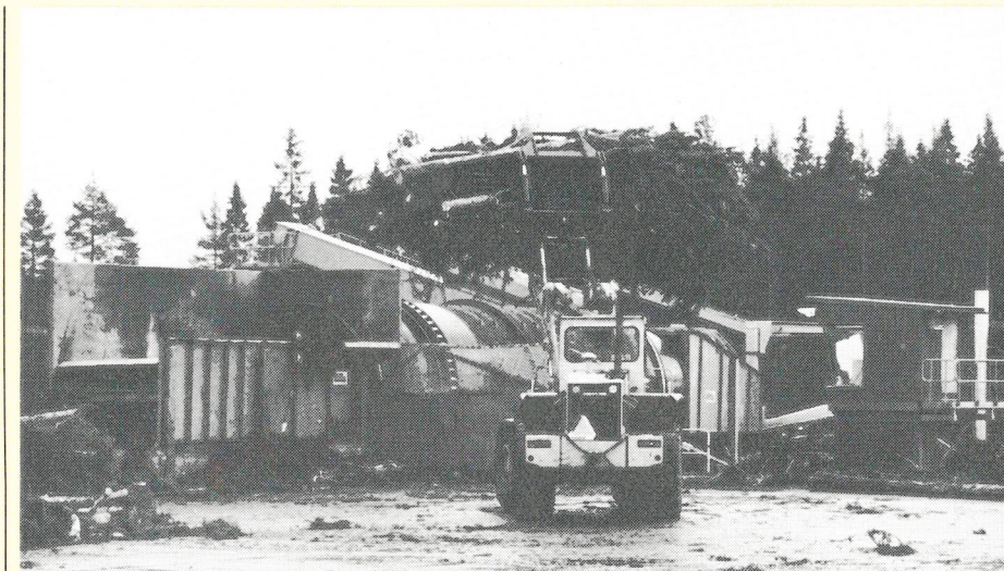
Här lastas träddelarna in i kvistningstrumman...
