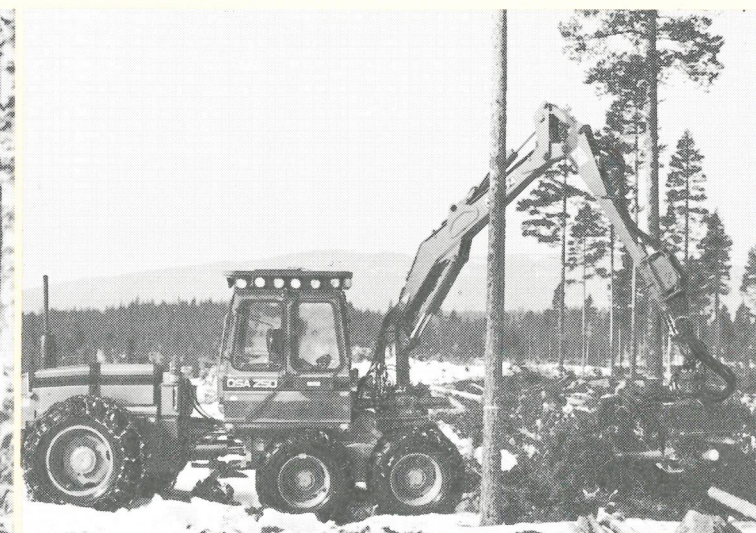
ÖSA 250 engreppsprocessor med hytten flyttad till vagn delen. Kranen, monterad på tiltplatta och placerad nära föraren.
