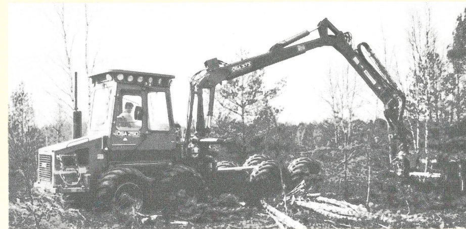
Nu finns det möjligheter att komma ut på ca 11 m med SP21 engreppsskördaren.
