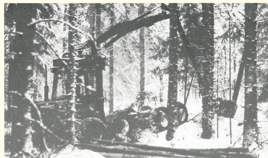
Bruunett mini med SP21 engreppsskördare är en smidig och lönsam gallringsmaskin. Efter montering av bankar och gripare sköter samma maskin uttransporten av virket.
