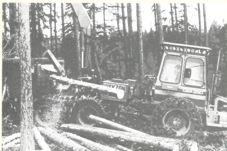
Tvågreppsskördaren ÖSA 706/250 med Hultdins fällgripare F55.
