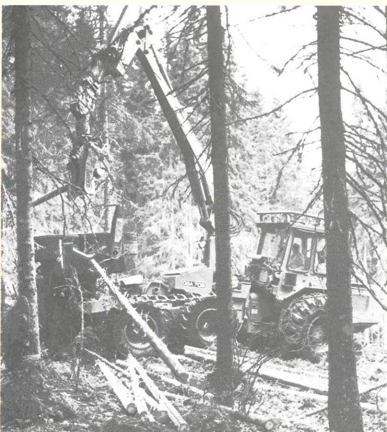
Tvågreppsskördaren ÖSA 706/260 i arbete. Sista biten på väg och nästa träd i väntläge är idealet.
