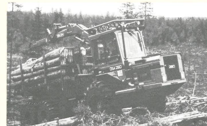
ÖSA 260 12 tons skotare och basmaskin för ett stort antal utrustningar. Marknadens första skogsmaskin med hydrostatisk transmission. I år levereras bl a 10 st till Australien.
