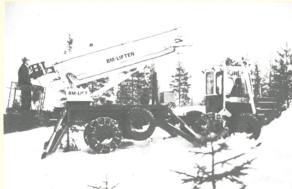
Här har föraren Lasse Nyhlén kört fram maskinen i positionsläge och kommit upp i arbetskorgen...
