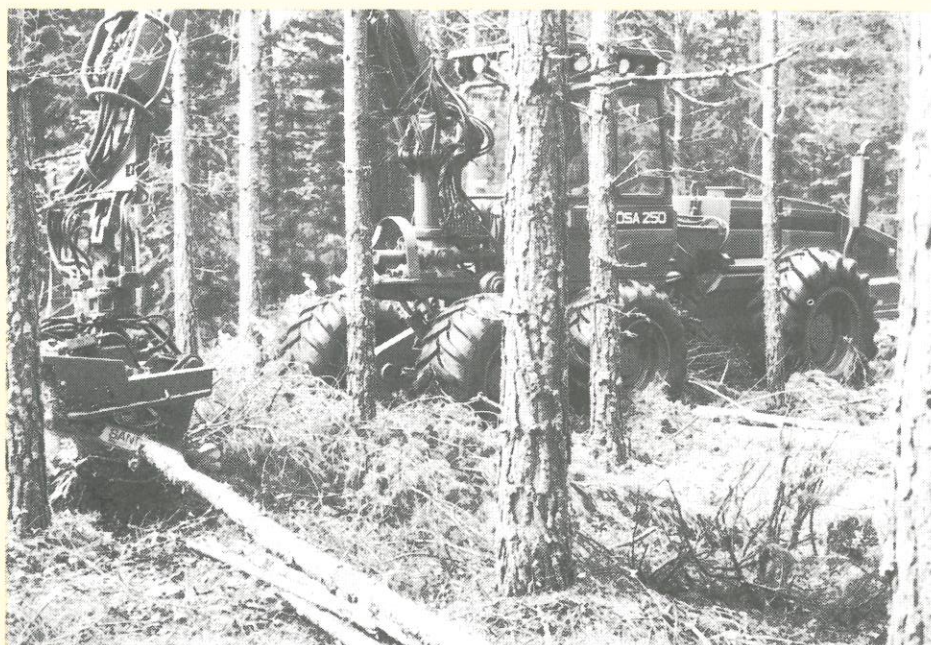
ÖSA 250 E med flyttad hytt och kran är en stabil och smidig bärare av engreppsskördare.
