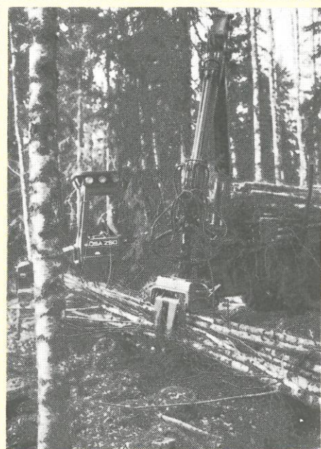
ÖSA 250 gripsågsskotare "kör hårt" framför allt i norrländska gallringsskogar.
