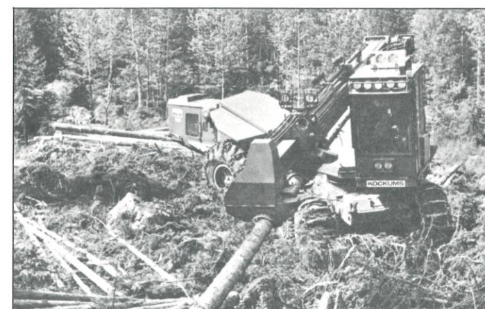
Logman tillhörde de första mobila kvistningsmaskinerna.
