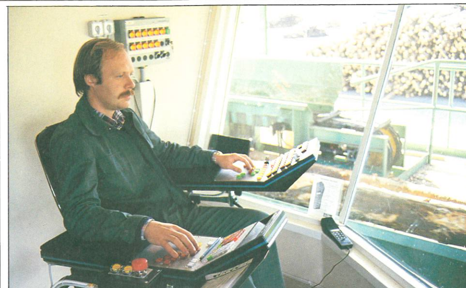
När stammen passerar mätramen mäts dess form avseende längd, diameter, krok och avsmalning. Hasse Eriksson är maskinoperatör.
