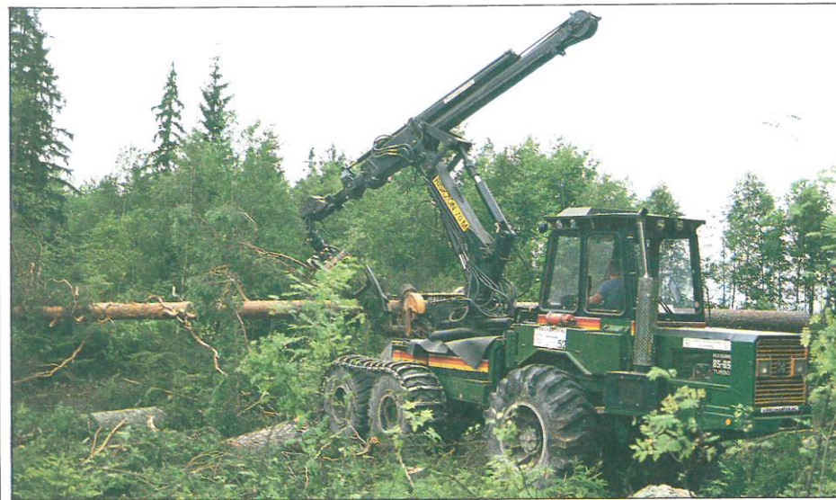
Kockumsprocessorn har inga problem att kvista de grova och kvistiga träden. Det krävs två lunnare att hålla processorn igång. Kvistningen sker på avlägg.
