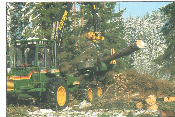
Masterskördaren, 707/280, med datorstödd aptering och hög prestationsförmåga.
