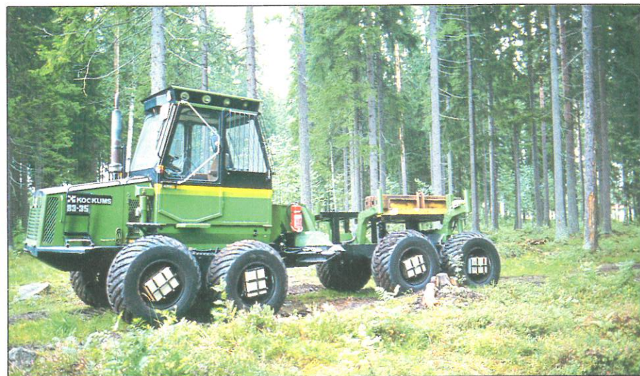
Försöksmaskinen (en 83-35, något ombyggd) har mätaxlar för samtliga hjul, varvtalsgivare på samtliga hjul, givare för styrutslag och boggivinklar samt ett mikrodatorbaserat mätinsamlingsystem (lådorna i hjulen).
