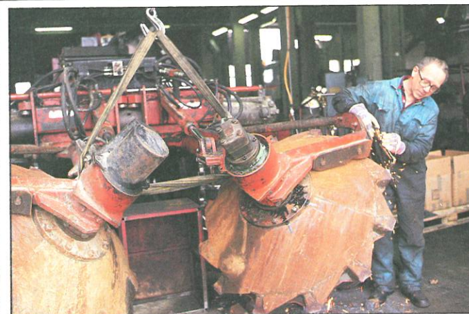
Montör Tord Viberg byter tändar på markberedaren.
