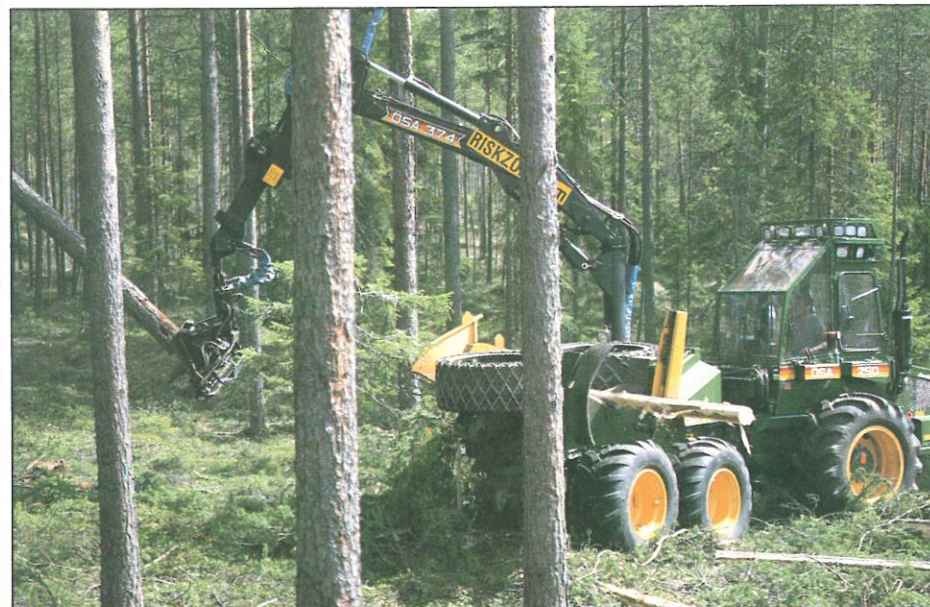
ÖSA 707/250 är en avancerad skördare, med hög förarkomfort och datorstyrd aptering.
