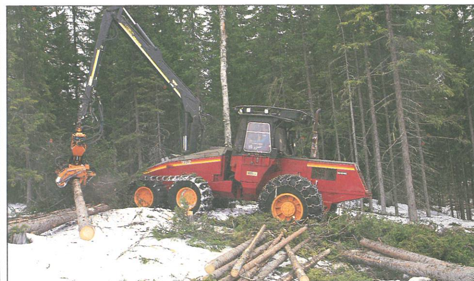
Så här blev resultatet när tvågrepparen byggdes om till engreppare.
