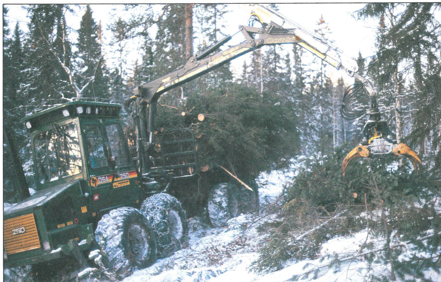
Träddelsskördaren, en intressant maskin för tvåskiktad slutavverkning.
