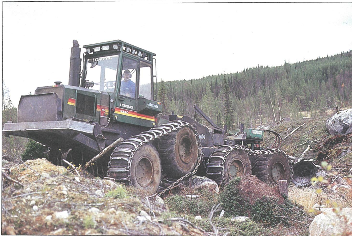
Den kraftiga 933-markberedaren har inga bekymmer med den steniga och branta terrängen.
