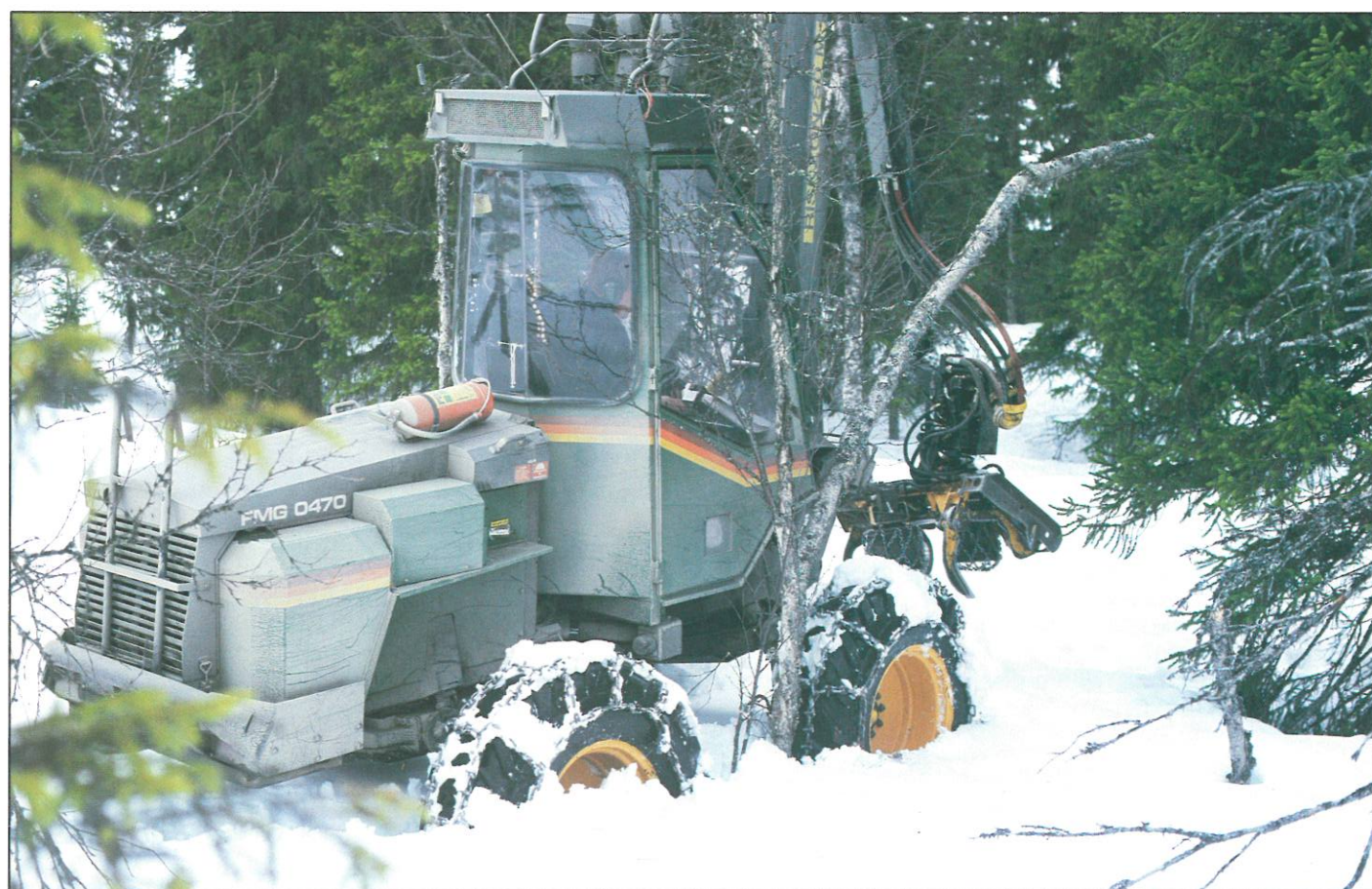
Snöproven visade att 0470 Lillebror klarade ett snödjup på drygt en meter.
