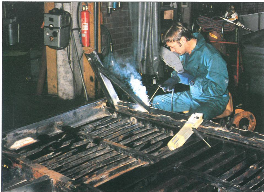
Torne Nilsson reparerar en lastgrind — den del av skotaren som får "mycket stryk"!
