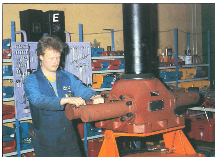
Vridhus och kranpelare monteras till ett separat "paket". Här monterar Lars Rosén anslutningsnipplar på vridhuscylindrar.
