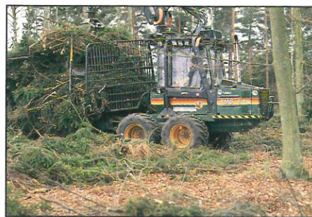
Här tar man rätt på toppar och grenar. Det är viktigt att det inte följer med något grus i lasset.
